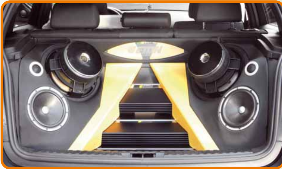
Unter der Verstärkertreppe sitzt die Elektronik. Trotz fehlender Reserveradmulde findet die Gelbatterie ebenfalls Platz
