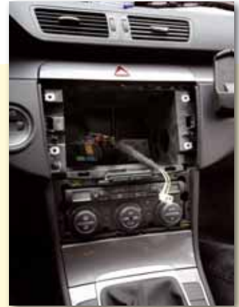
Das Originalradio wird ausgebaut, um die Upgrade Box anzuschließen
