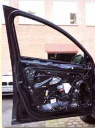
Die Türverkleidungen und Spiegeldreiecke müssen runter, dazu werden die Nieten aufgebohrt
