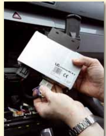
Die Box findet unter dem Originalradio ein perfektes Plätzchen. Zur sicheren Montage dienen original vorhandene Schrauben
