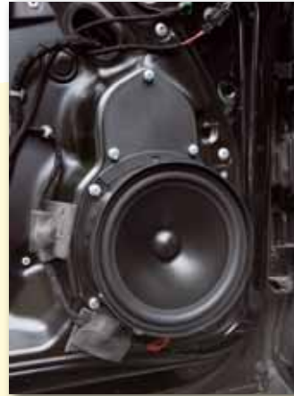
Die Upgrade-Tieftoneinheit passt mitsamt Weiche genau die in Originalöffnung und wird mit Dichtband angeschraubt
